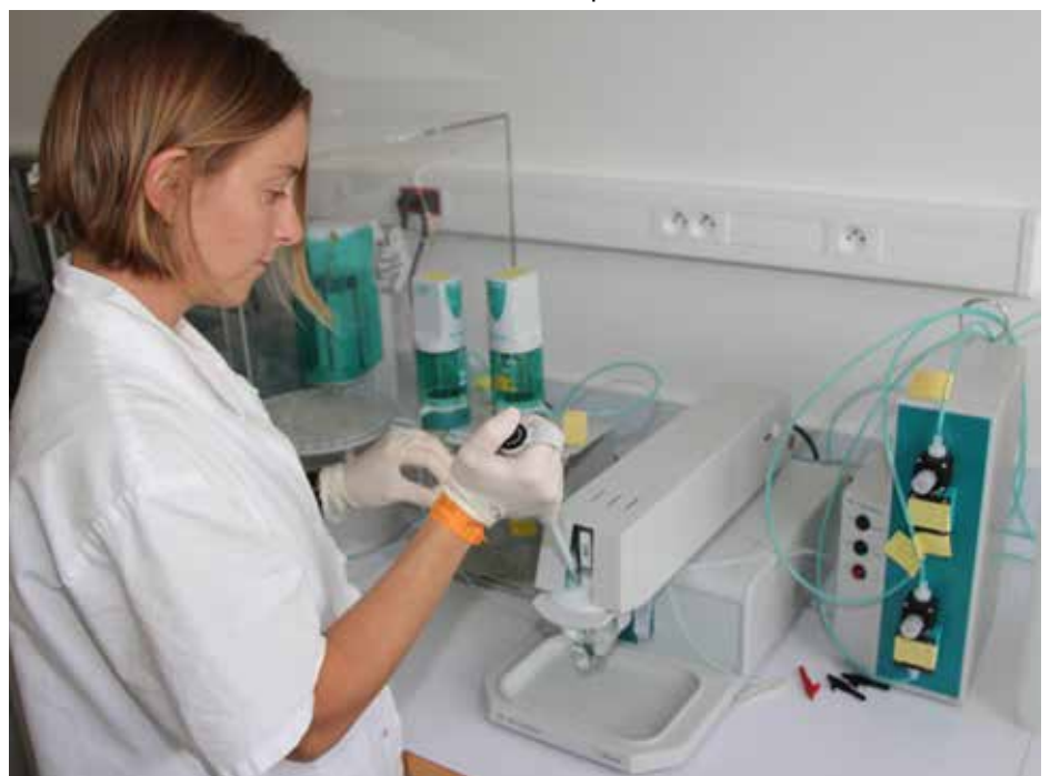
Ingénieur chimiste effectuant une analyse de Cr (VI) par Voltammétrie au laboratoire AEL.
